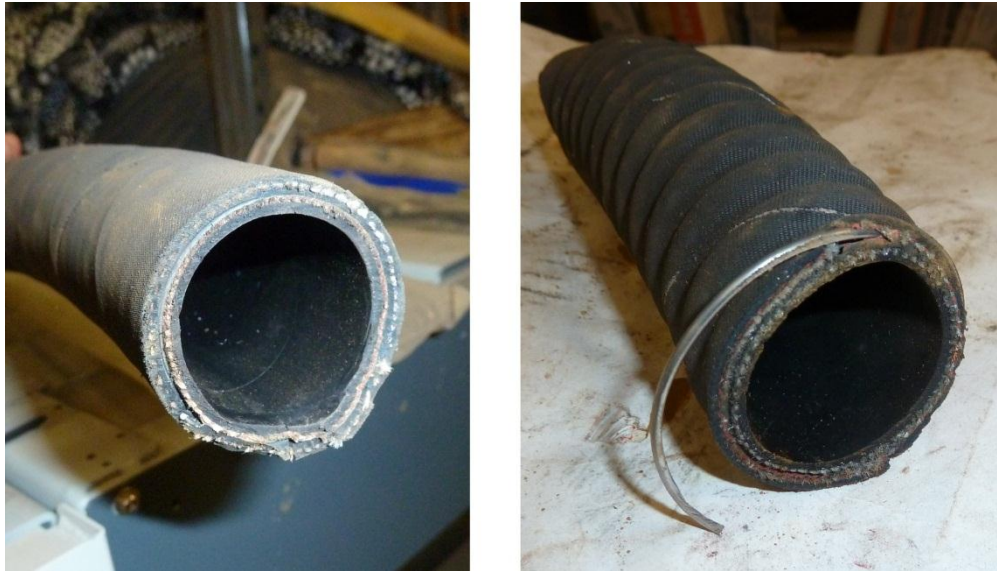
Joonis 11. Katsestes kasutatud armeeritud kummist kõrgrsurve voolikud
