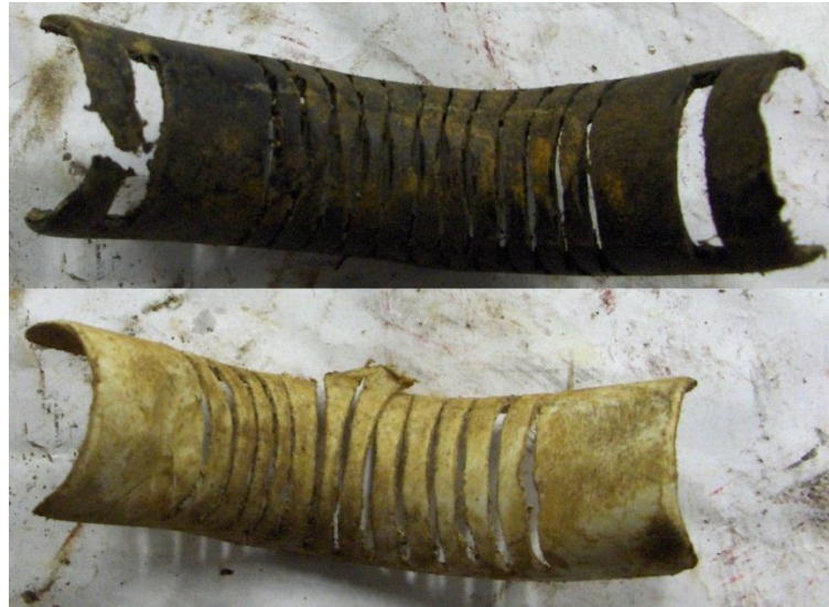
Joonis 10. Katsetes kasutatud plastikust kaitsed, must kõrge tihedusega polüetüleenist, hele polüpropüleenist
