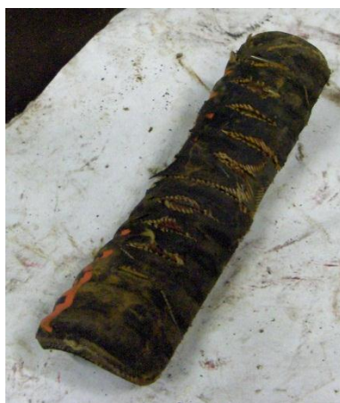
Joonis 14. Rohkem kulunud kaitse vasakul. Vähem kulunud kaitse paremal
