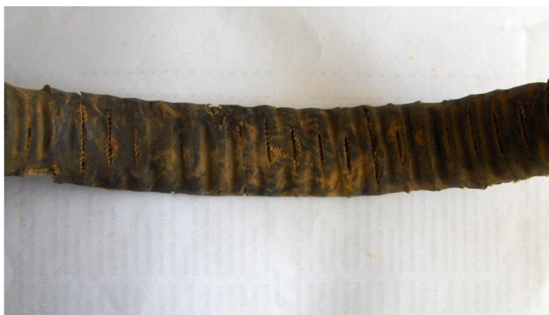
Joonis 14. Rohkem kulunud kaitse vasakul. Vähem kulunud kaitse paremal
