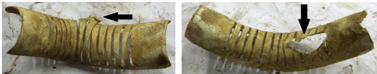
Joonis 15. Kaks enim kulunud kohta kaitsmetel
