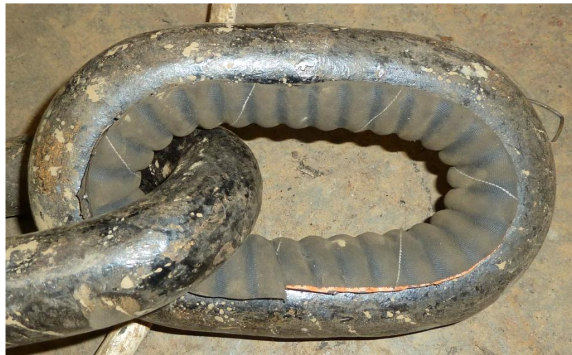
Joonis 13. Ketilülile paigaldatud täispikk kummist kaits
