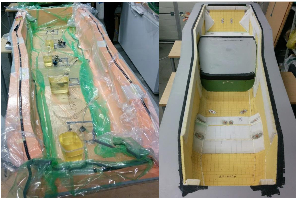
Sele 9.5. Välimise laminaadikihi infusioonimine (vasakul) ja vahust vahekihi paigaldamine (paremal)
