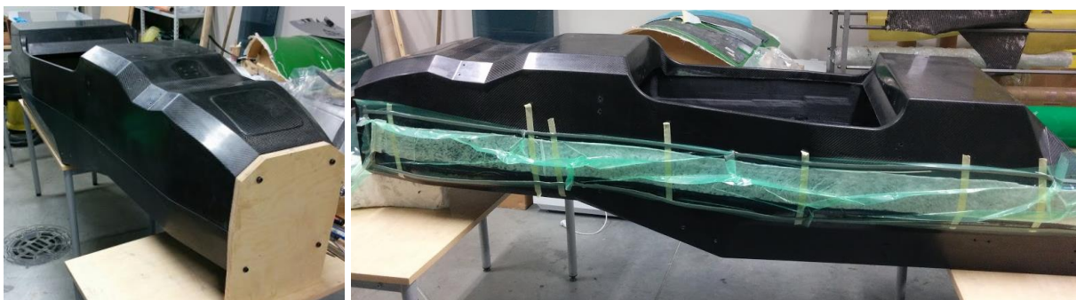
Sele 8.4. Liimimisrakises kere pooled ning liite ülekatte lamineerimine
