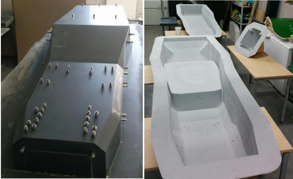
Sele 8.2. Positiiv vorm positsioneerimispuksidega ning valminud negatiiv vormid
