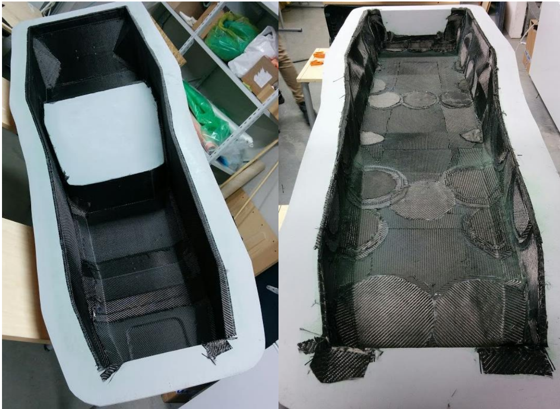
Sele 9.4. Välimise laminaadi kihi lamineerimine
