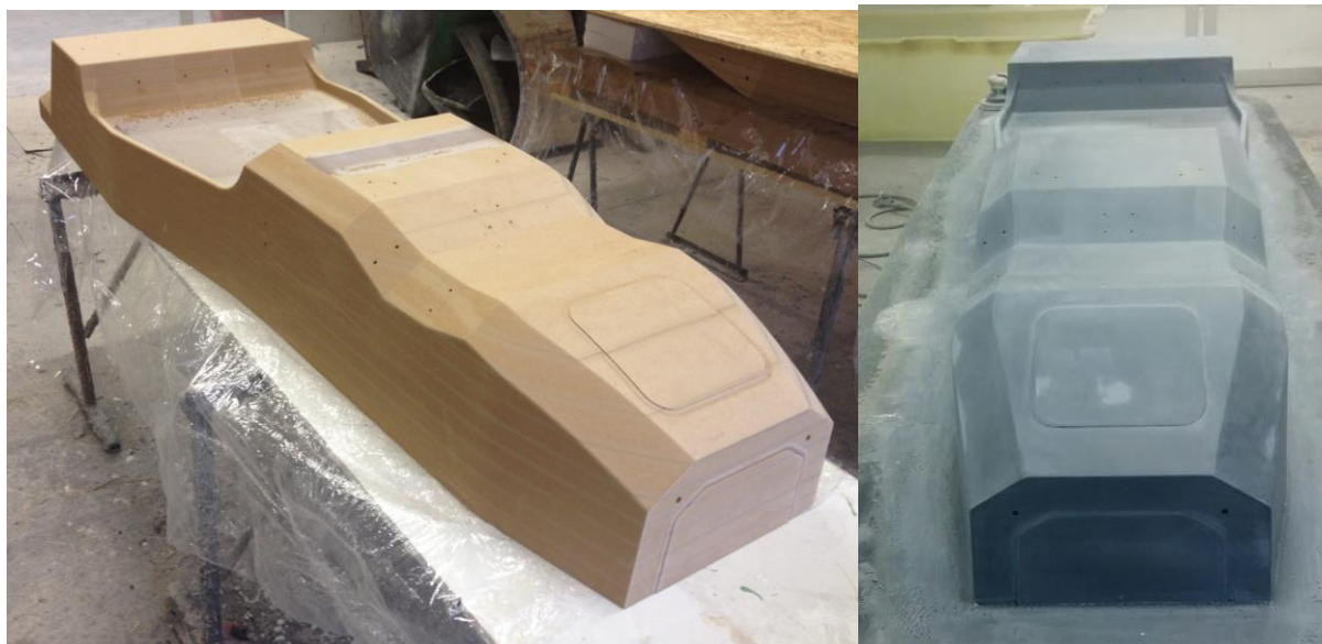
Sele 9.2. Kere positiiv mudel peale freesimist ja peale pahtlipinna lihvimist
