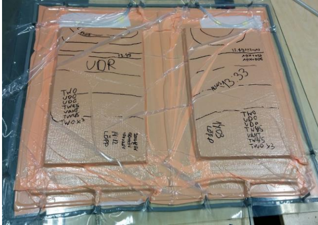
Sele 5.14. VAP membraankangaga kaetud katsekehade infusioonimine
