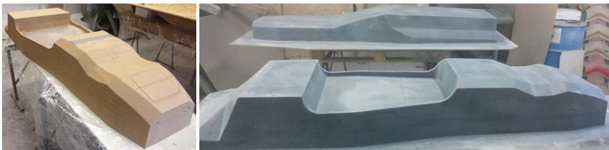
Sele 8.1. Kere positiiv vorm enne ja peale pinnatöötlust
