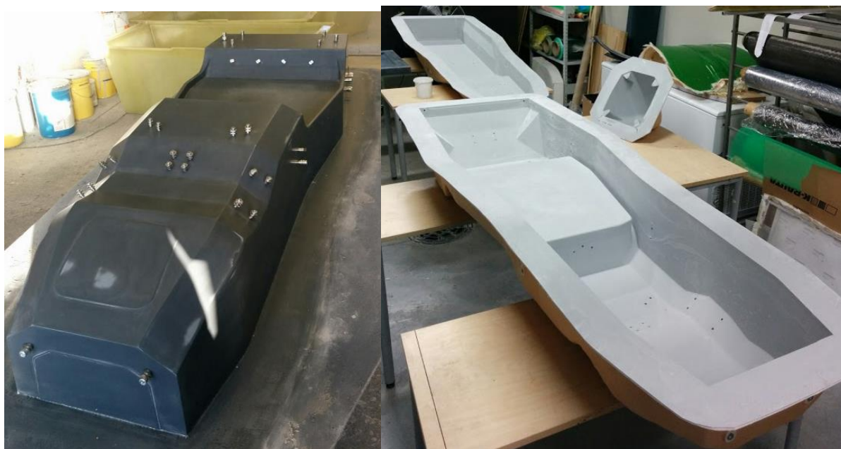
Sele 9.3. Kere positiiv ette valmistatud negatiiv vormi lamineerimiseks ja valmis negatiiv vormid
