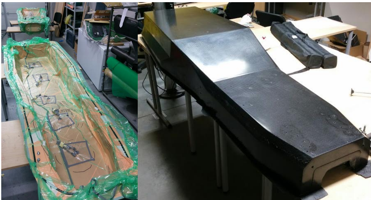
Sele 9.7. Sisemise laminaadikihi infusioonimne (vasakul) ja valmis kere alumine pool (paremal)
