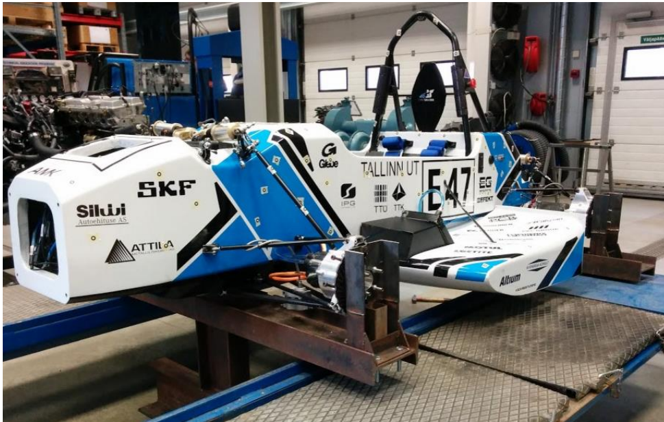
Sele 1.1. Väändejäikusrakisesse paigutatud vormel FEST15
