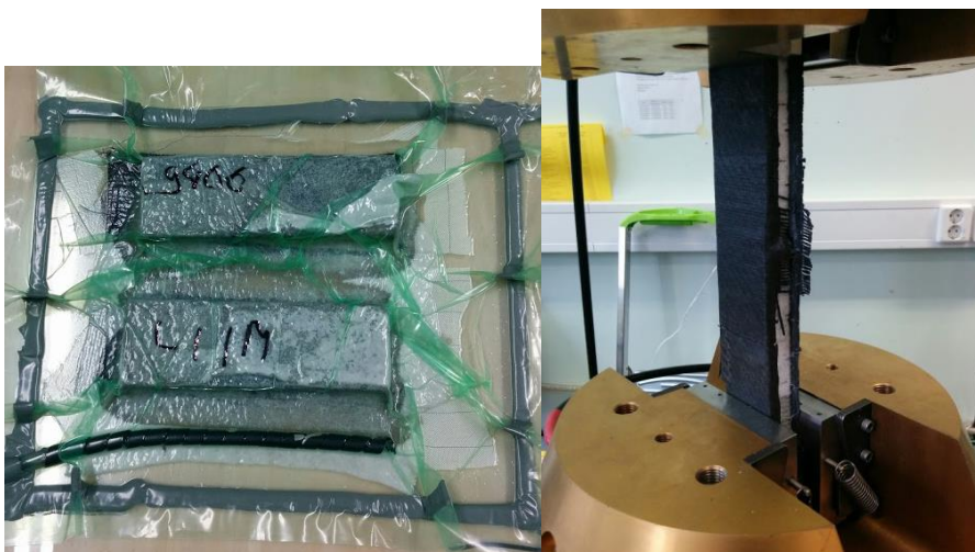
Sele 6.3 .Liimliite katsekeha valmistamine ja katsekeha tõmbepingis
