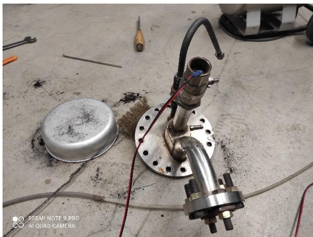
Joonis 23 - Reaktori puhastamine
