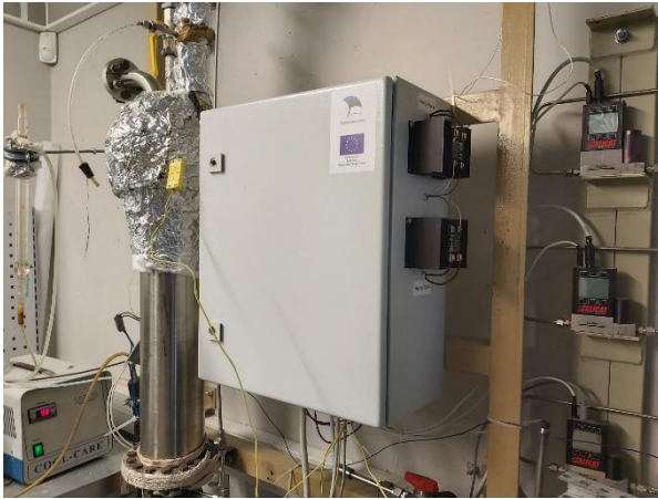
Joonis 21 - Reaktor koos gaasivooluregulaatoritega (jahutussüsteem eemaldatud)
