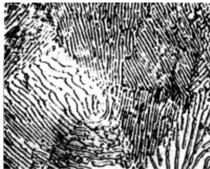
Joonis 3.19. Eutektoidstruktuur (perliit) (suurendus 500 korda)
