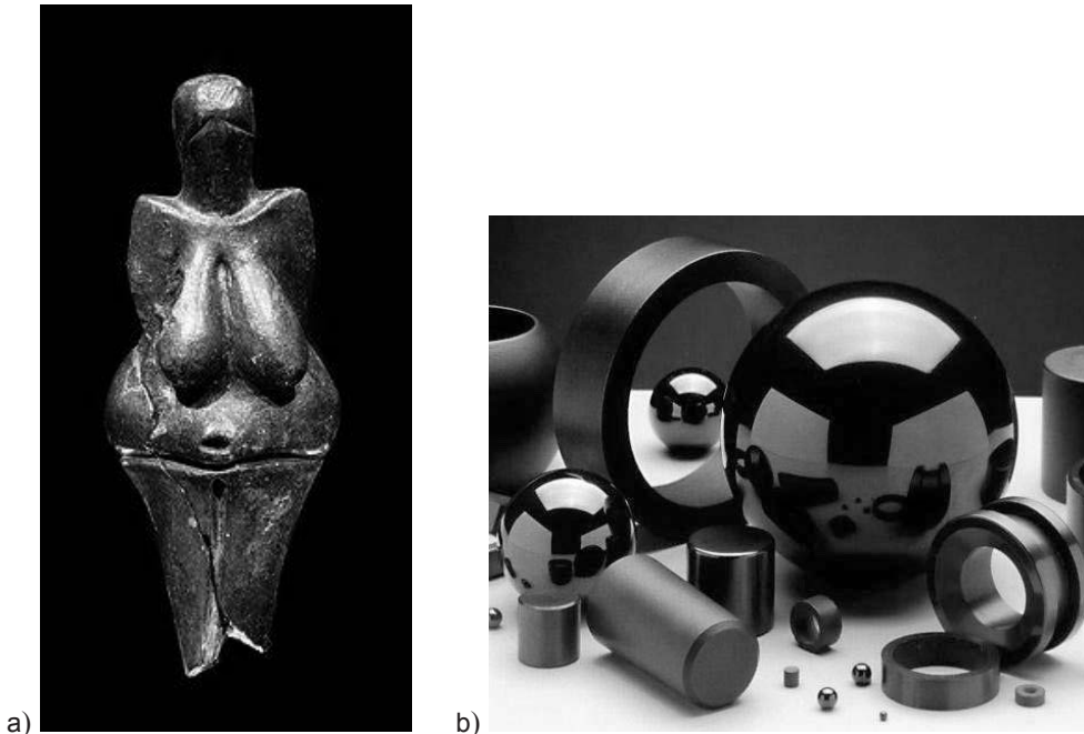
Joonis 6.13. Teadaolevalt vanim keraamiline kujuke (a) Dolni Věstonice Veenus leiti 1925. a Brno lähedalt; nüüdisaegne tehnokeeraamika \text{Si}_3\text{N}_4 baasil (b)
