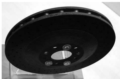
Joonis 6.23. Süsinikkomposiidist piduriketas
