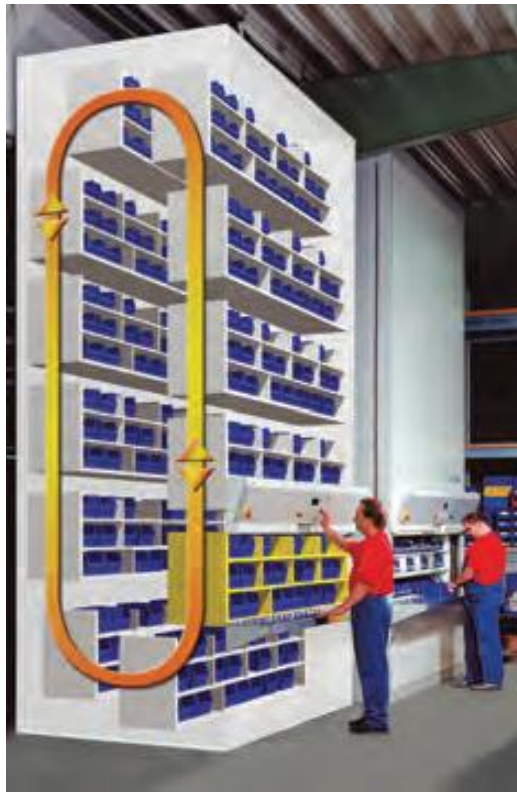
Sele 5.1. Karussellsüsteemiga tornlao tööpõhimõte [104]
