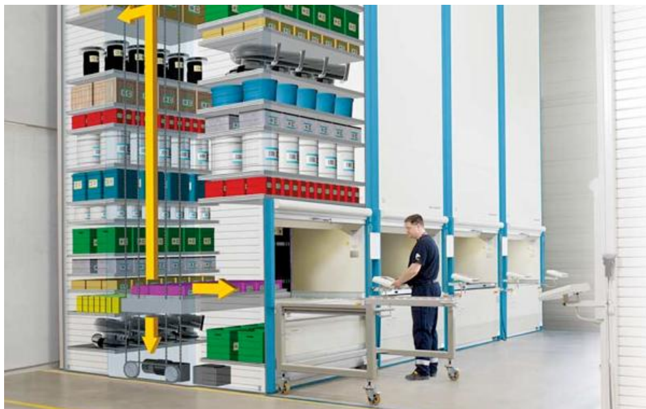
Sele 5.2. Sahtel-lift süsteemiga tornlao tööpõhimõte [105]
