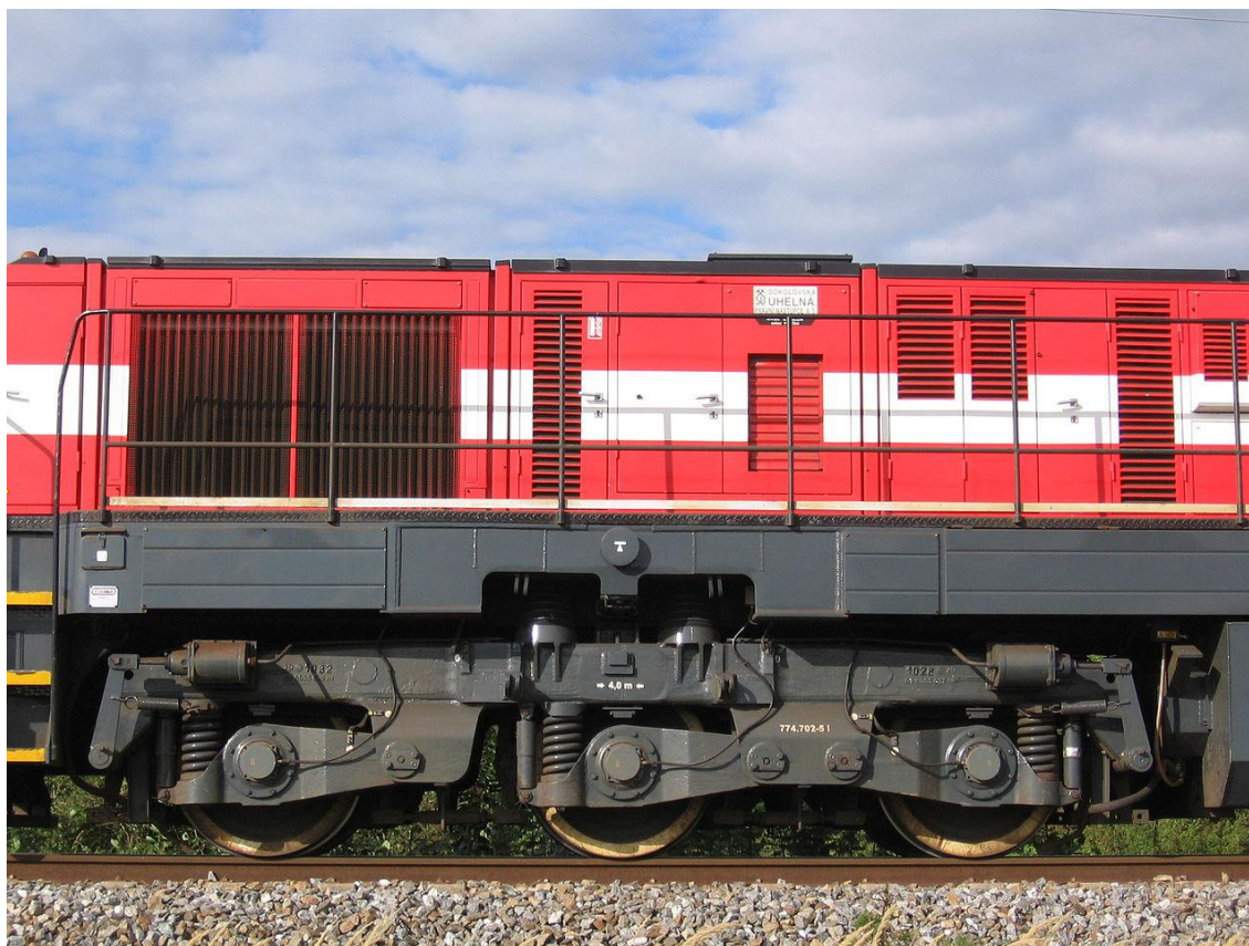
Joonis 6.3 Veduri ChME3 modifitseeritud vanker [18]
