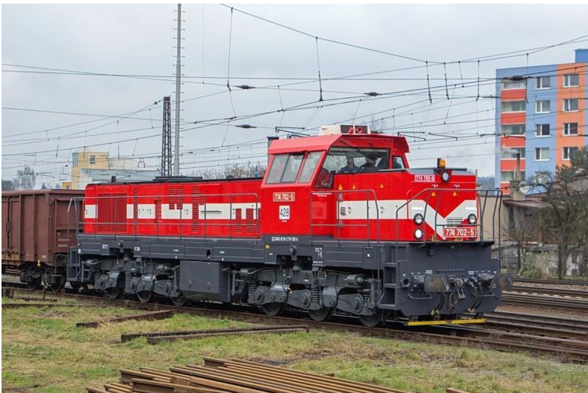
Joonis 6.1 Moodulitest koosnev kapottkerega vedur ChME3 [16]
