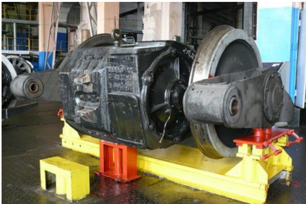
Joonis 6.4 Veduri ChME3 veomootor koos rattapaariga [25]
