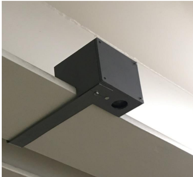
Joonis 2. Laevatekile paigaldatud sensori prototüüp [9].
