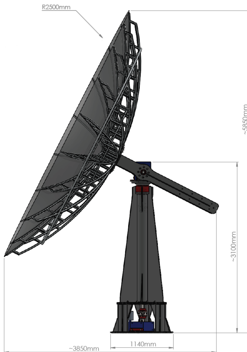
Joonis 1. Paraboolantenni mõõtmed.
