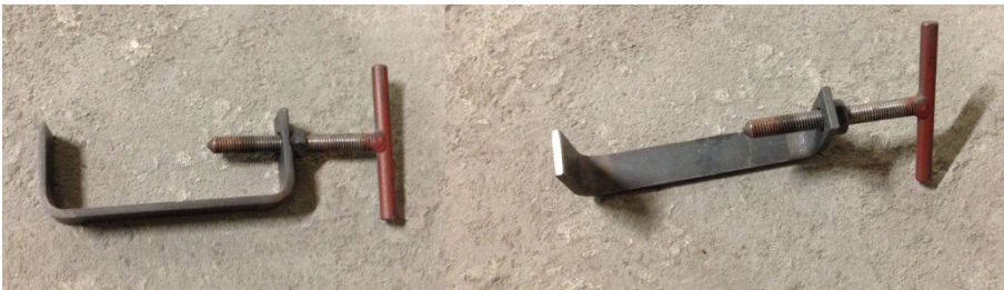
Sele 1.7 Klambrid, millega kinnitatakse paneel mõõteraami külge
