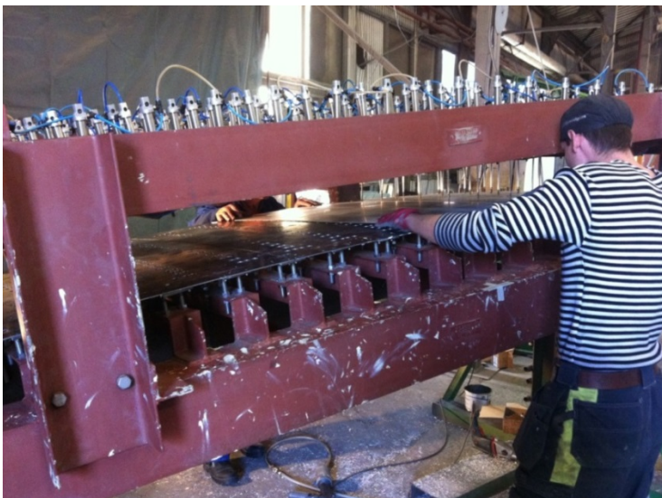
Sele 1.5 Paneelide valmistamise vorm ning alumiiniumlehtede vormi ladumine
