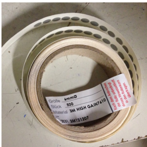
Sele 1.12 Peegeldavad kleebised paneeli nullpunktide tähistamiseks paneeli pinnal
