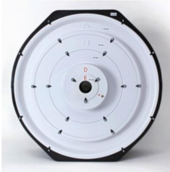
Joonis 3.7. BlowerDoor mõtteseadme ventilaator [39]
