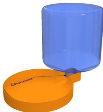
Joonis 3.9 - Gravitatsiooni toimel täituv joogikauss
