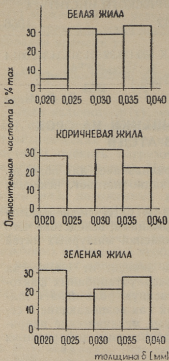
Фиг. 1. Статистическое распределение толщин плющенко мширных нитей по отдельным жилам исследуемого шнура АТСДИ-3.
