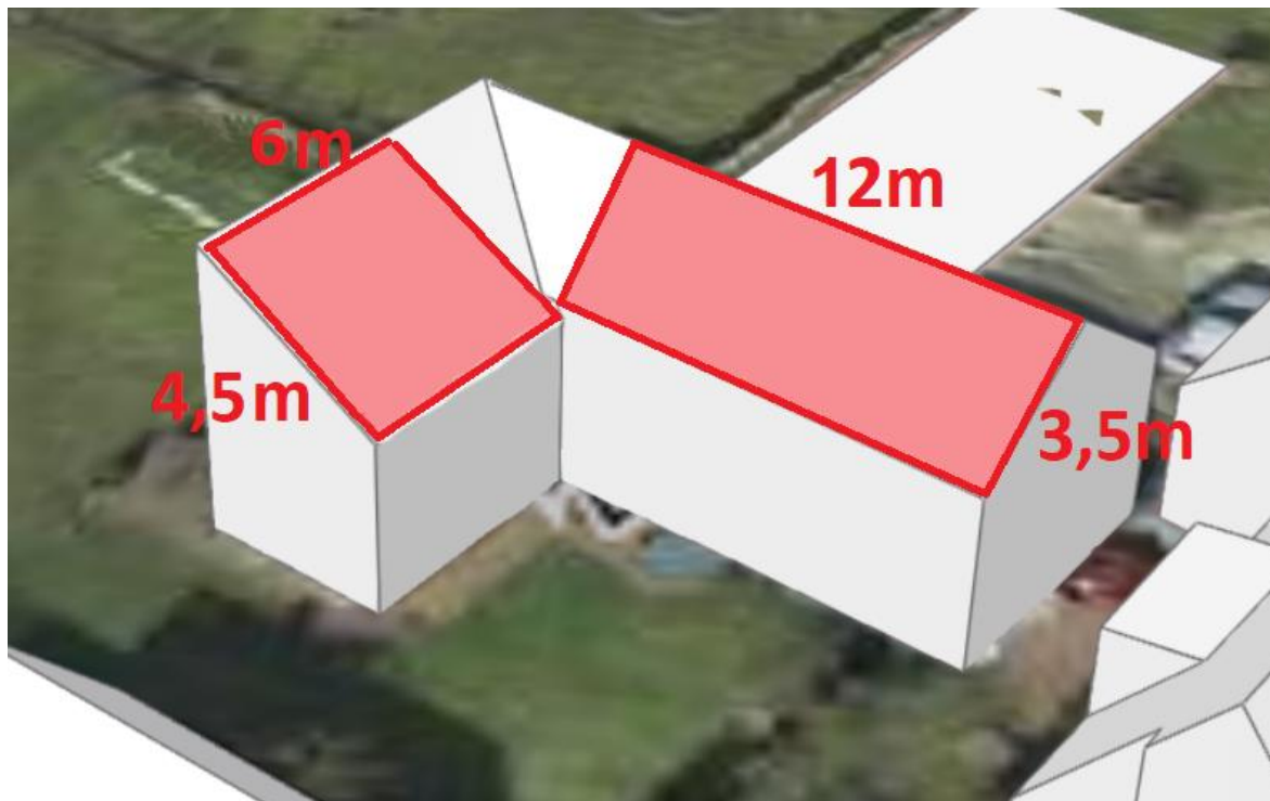
Joonis 4.3 Päikesepaneelidega kaetavate katusepindade mõõdud. [17]
