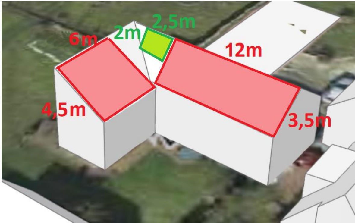
Joonis 4.4 Päikesepaneelidega (punaselt) ja päikesekollektoriga (rohelist) kaetavate katusepindade mõõdud. [17]
