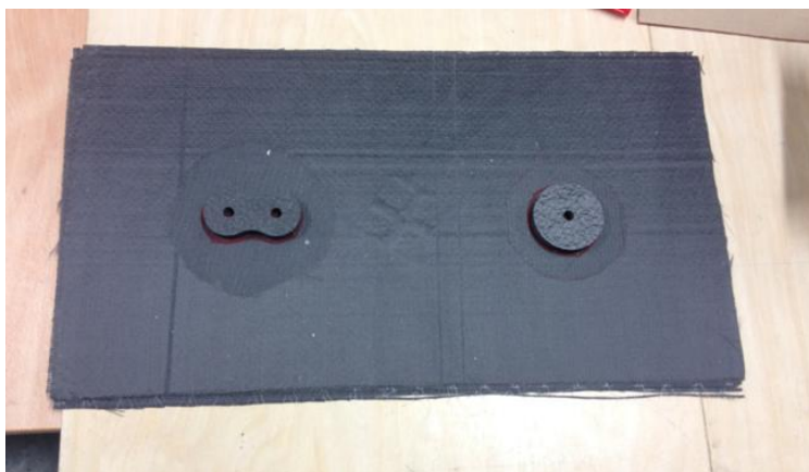
Sele 3.15. Süsinikust valmistatud kinnitusankrud
