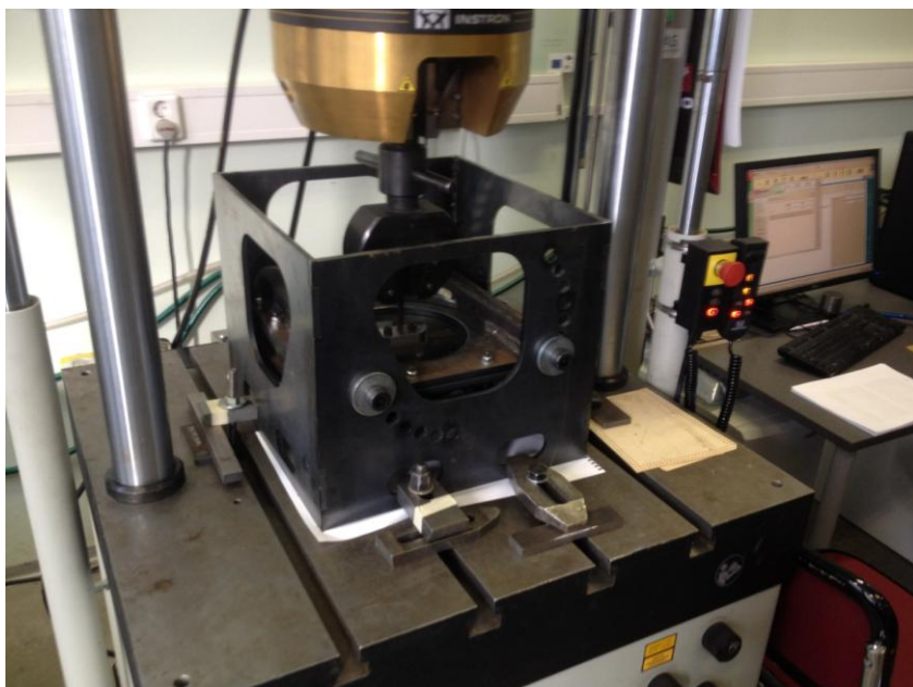
Sele 2.13. Rakise kasutamine laminaadi testimisel
