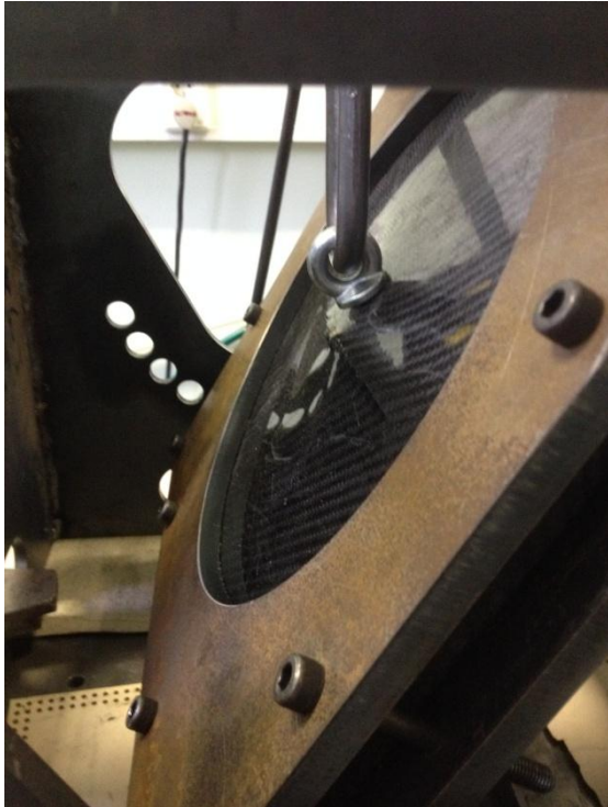
Sele 4.3. Sukeldumisvastase rihma ning õlarihma alumise kinnituse katsetus
