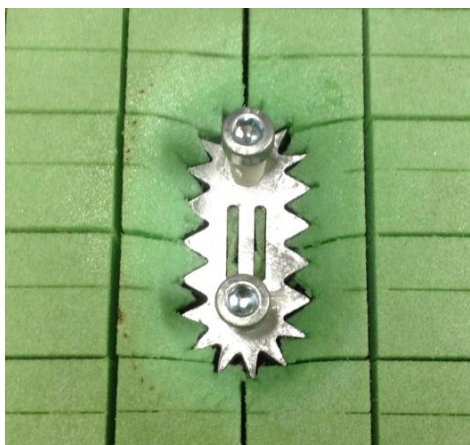
Sele 3.26. Kausikujulise vahu ning tähekujulise ankru lahendus enne lamineerimist.
