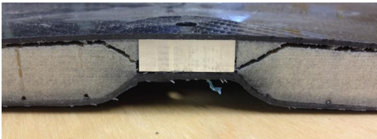
Sele 3.29. 19 mm paksuse vahuga laminaadi lõikepind.
