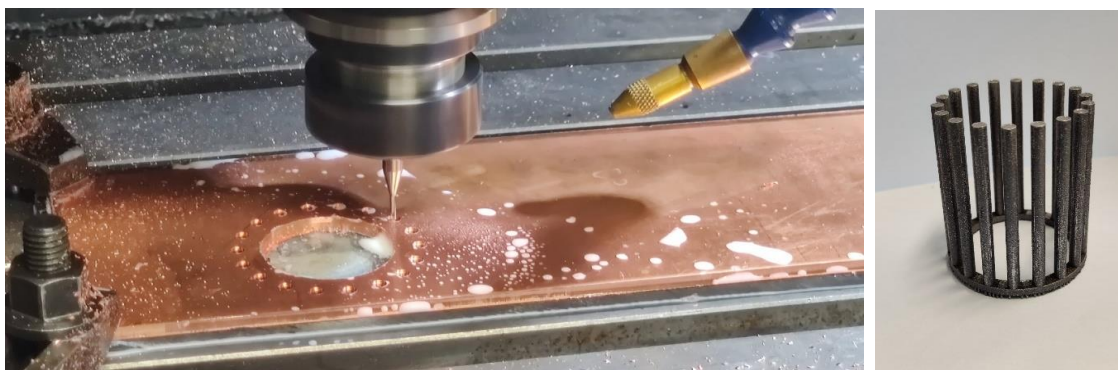
Joonis 2.9. Lühisrõngaste valmistamine (vasakul). Varraste ja lühisrõnga printimise katse (paremal).
