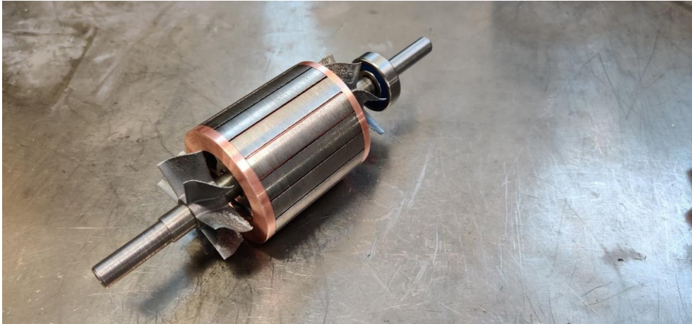
Joonis 2.11. Rootori südamik koos lühisrõngaste, varraste, võlli, laagrite ja jahutuslabadega.
