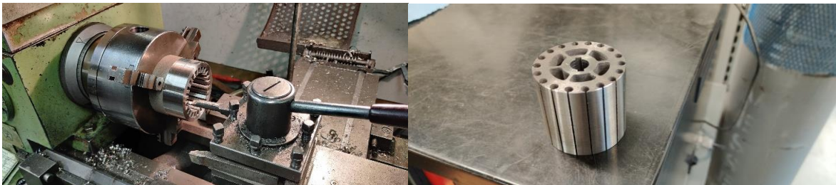
Joonis 2.8. Staatori südamiku soonte töötlus (vasakul) ja rootori töödeldud südamik (paremal).
