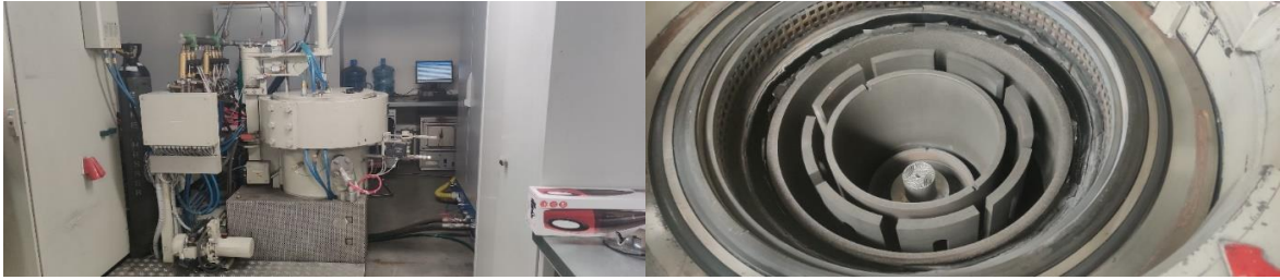
Joonis 2.7. Ahi osade lõõmutamiseks ja noolutamiseks.
