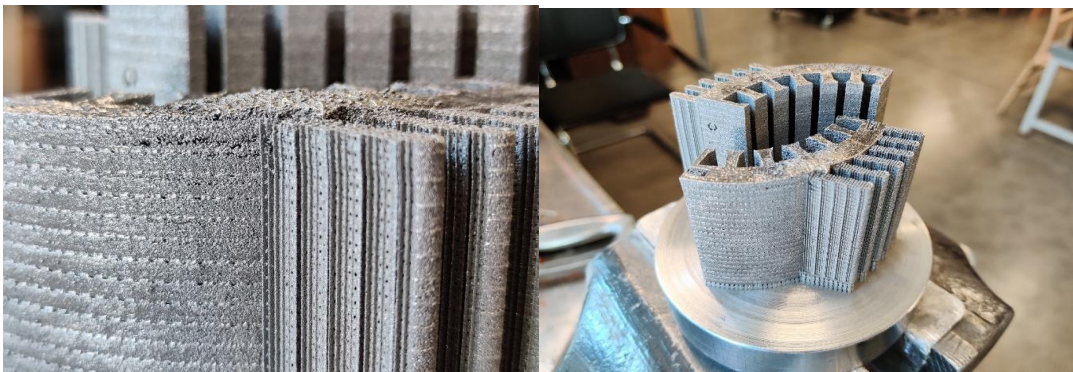
Joonis 2.6. Defektid printimisel.
