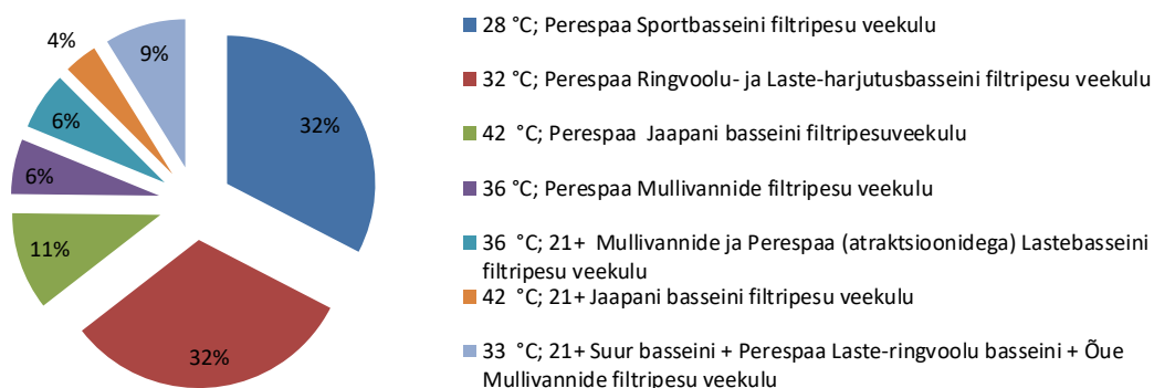
Joonis 3.26 Perioodil 15.02.2019...20.03.2019 basseinide filtripesu proovipesu meetodi veekulu jaotus
