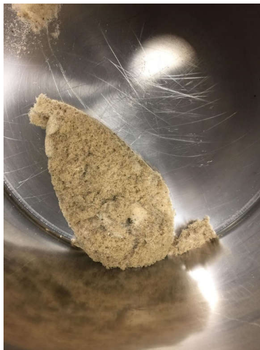
Joonis 4.2 Seadmega Retsch SM100 purustatud pesemata vill
