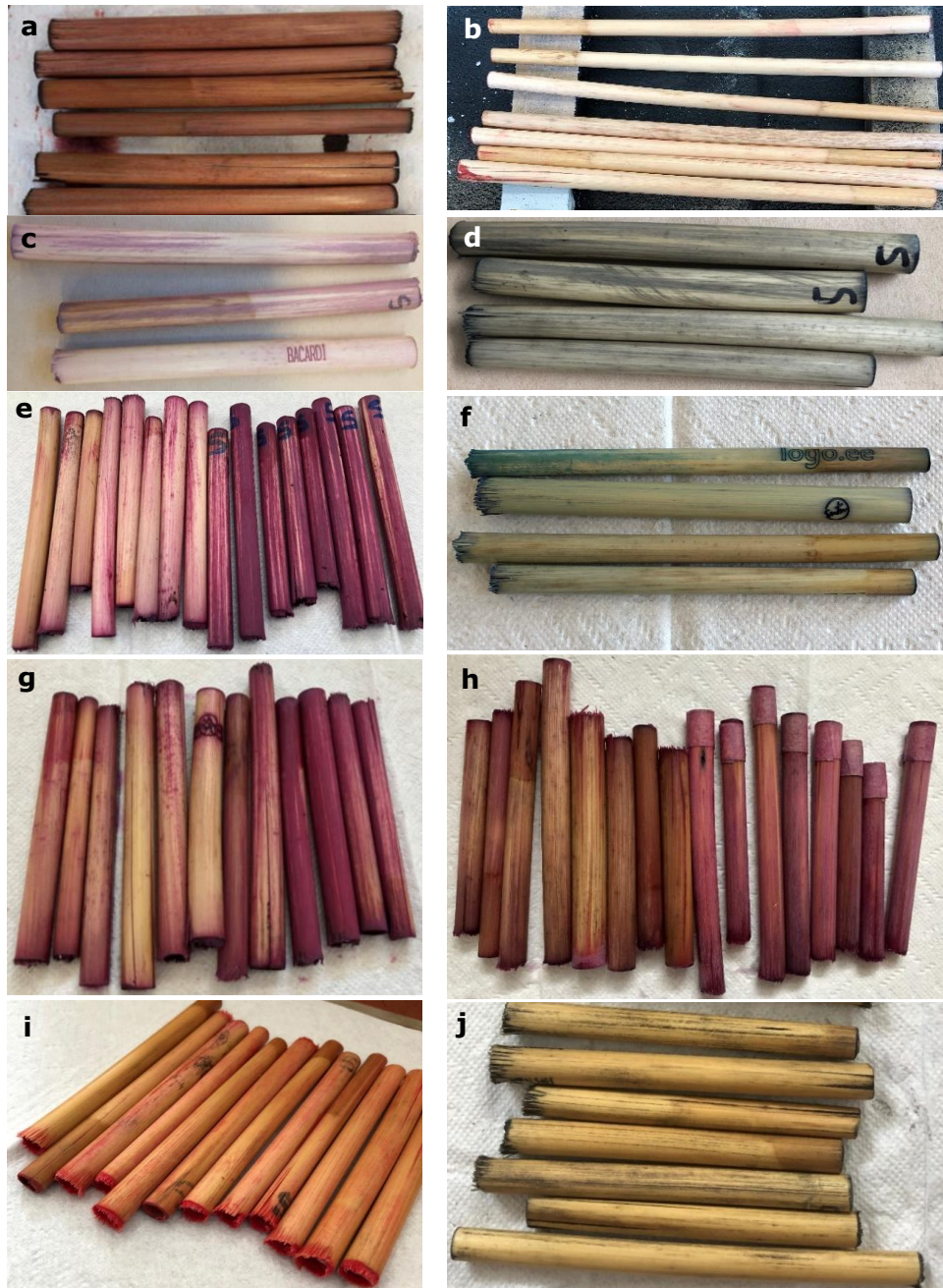
Joonis 4.3 Immutuse tulemused: (a) alkoholi baasil vedelik; (b) linaõlivärv + linaõli, lisaks 100g tärpentini; (c) mustsõstra mahl; (d) mustsõstra mahl + \text{Fe}_2\text{O}_3 ; (e) purustatud metsmustikad, S-karestatud; (f) mustsõstramahl ja PME sinine pasta; (g) purustatud metsmustikad + PME must toiduvärv; (h) purustatud mustsõstrad, teibiga kõrred karestatud; (i) etanool+vesi, 50/50 ja kinaver; (j) etanool+vesi, 50/50 ja \text{Fe}_2\text{O}_3 .
