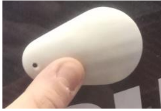
Sele 5.2 Laserpaagutatud katmik ning servo liidese stabilisaator
