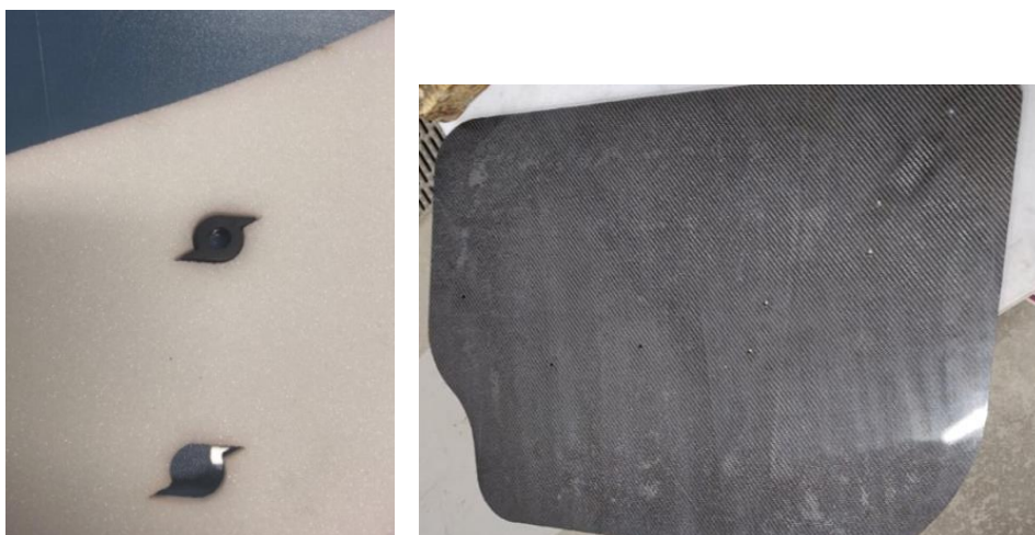
Sele 5.8 Otsaplaadi vaht koos insertidga ning lõplik otsaplaat
