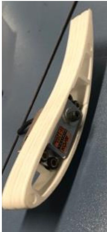
Sele 5.3 Laserpaagutatud mootori kinnitus rapid
