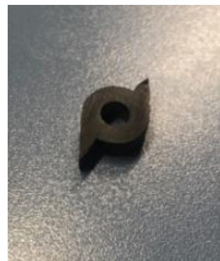
Sele 5.5 Laserlõigatud otsaplaadi vaht ning poldi kinnitus insert
