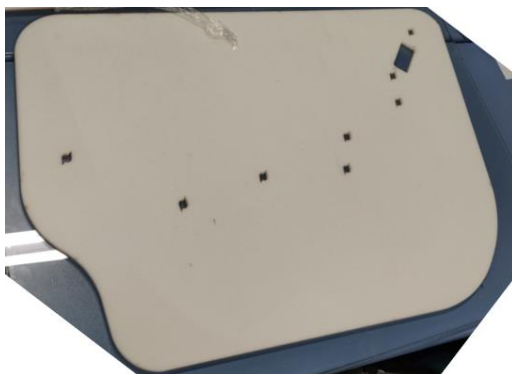
Sele 5.5 Laserlõigatud otsaplaadi vaht ning poldi kinnitus insert
