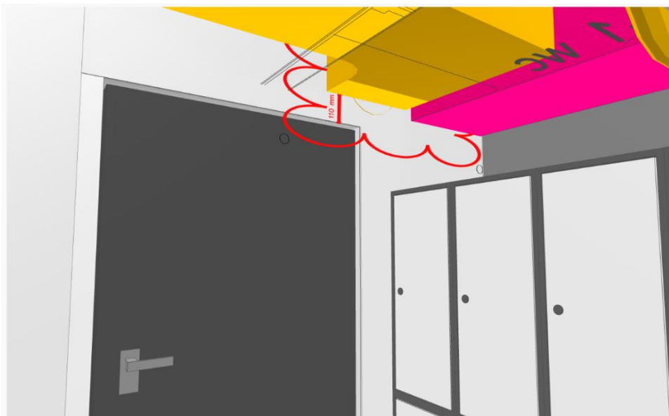
Pilt 1. Ukse silluse ja õhukanali ristumine (Projekt 2)
