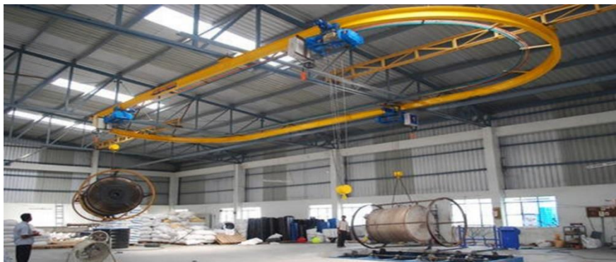
Joonis 6. Ringratta kujuline monorelss kraana.
