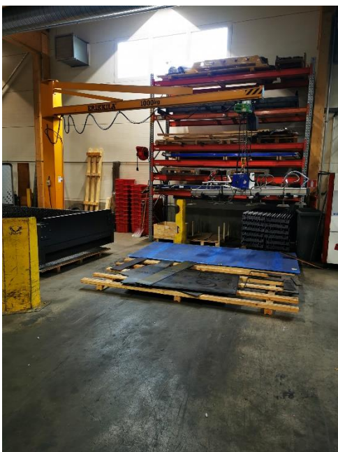
Joonis 9. Konsool paremale lükatuna. Edasi liikumist takistab riul.
