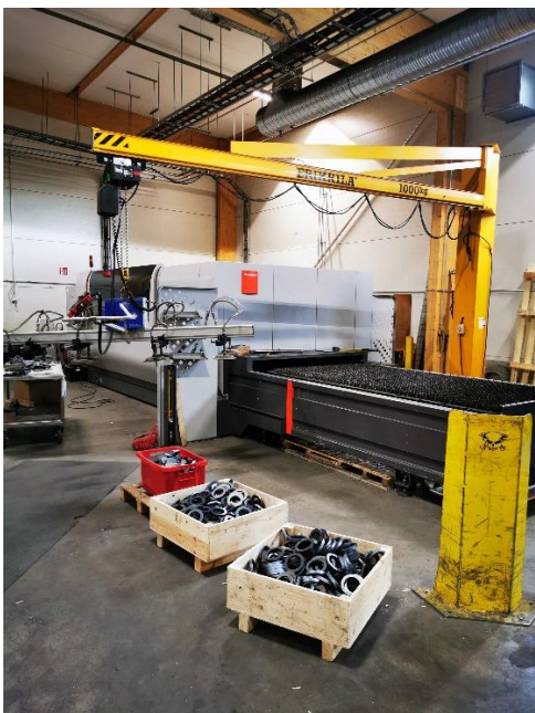
Joonis 8. Konsool vasakule lükatuna. Edasi liikumist takistab fiiberlaser.
