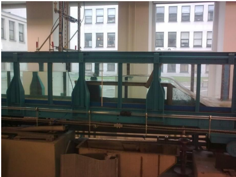
JOONIS 27-10 Nehatu paisu füüsiline mudel Tallinna Tehnikaülikooli hüdromehaanika teadus- ja katselaboratooriumis, Tallinn. (Foto: Janek Laanearu, 2010)
