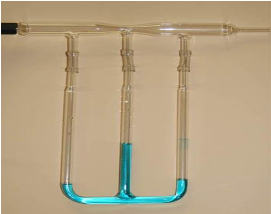
JOONIS 25-5 Bernoulli toru staatiline ja dünaamiline voolurežiim. (Erakogu)
