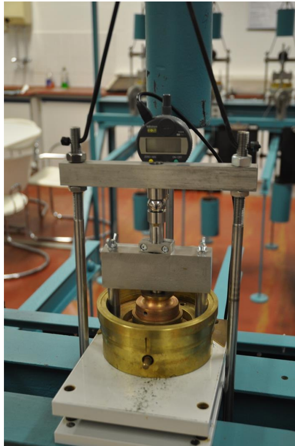
Joonis 1.4 Ödomeetri katseseade [11]
