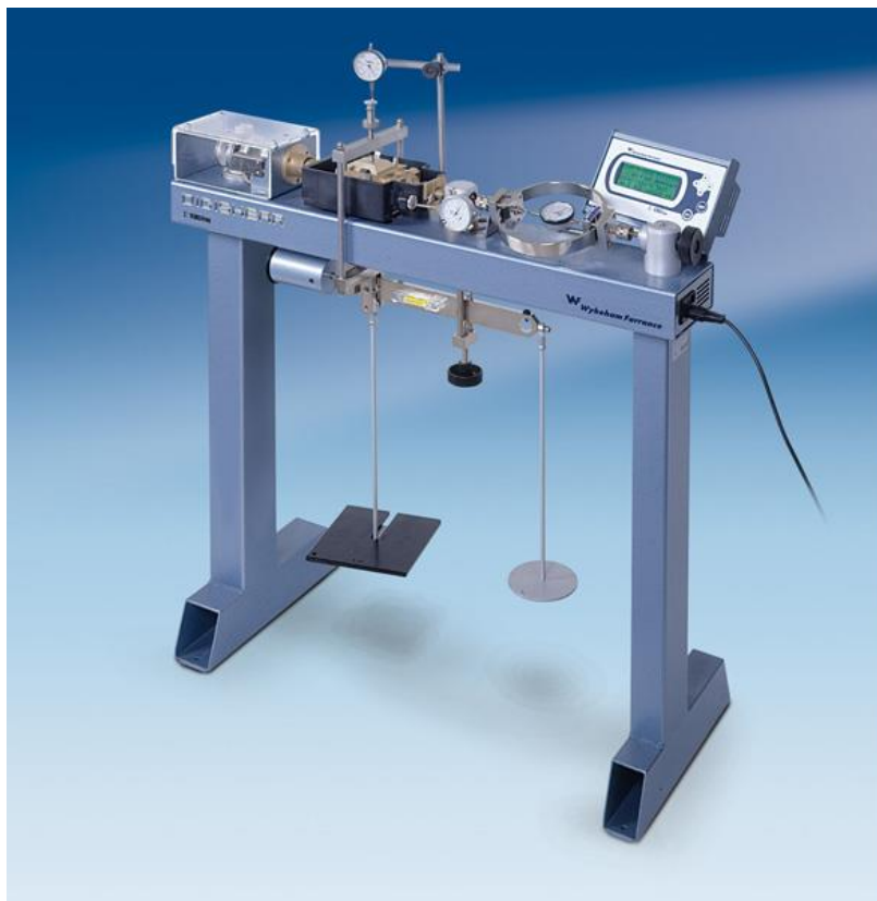
Joonis 1.3 Lõiketeimi katseseade nihketugevuse määramiseks [10]
