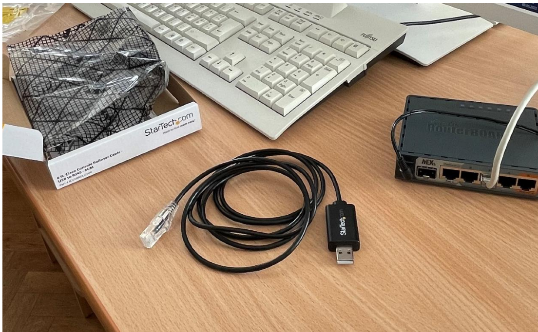
Joonis 3.2 Seadmed ja konsoolikaabel mis on vajalikud MikroTik seadistamiseks
