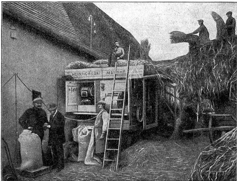
Joon. 1. Viljapeksumasin sisseehitatud elektrimootoriga.
