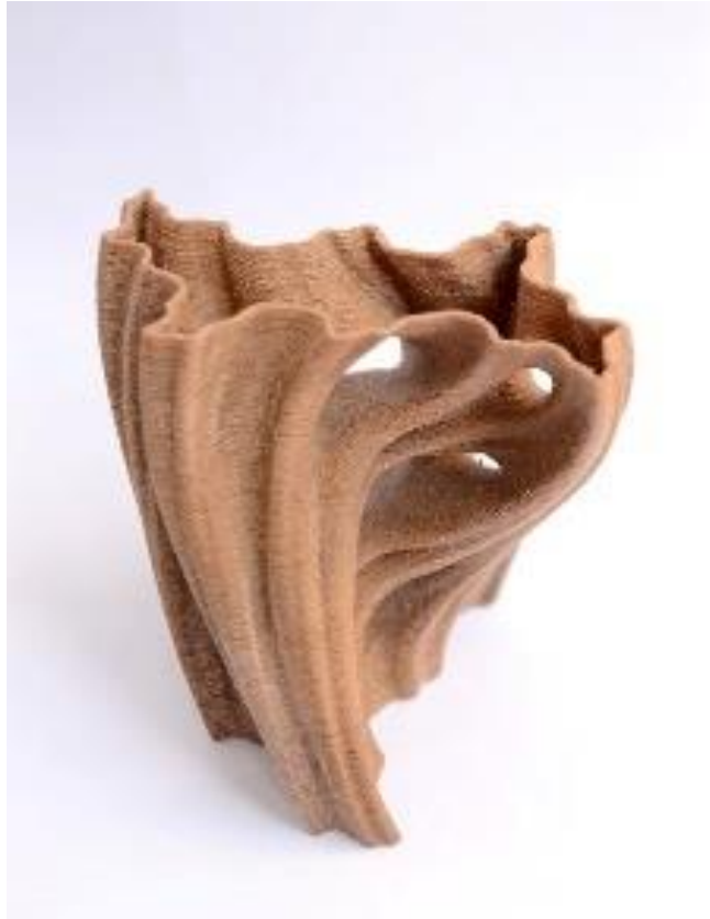
Joonis 3.2. 3CULAR saepurust 3D printimisel valmistatud tootenäidis (3CULAR 3D saepuru printer, 2018)
