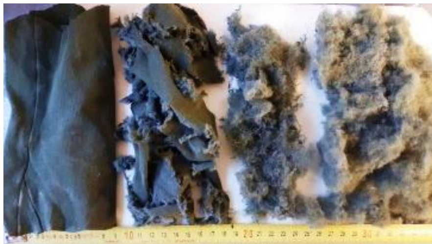
Joonis 4.3. Materjal nr 1 purustatud tulemused erinevatel peenestuselementide pöörlemiskiirustel
