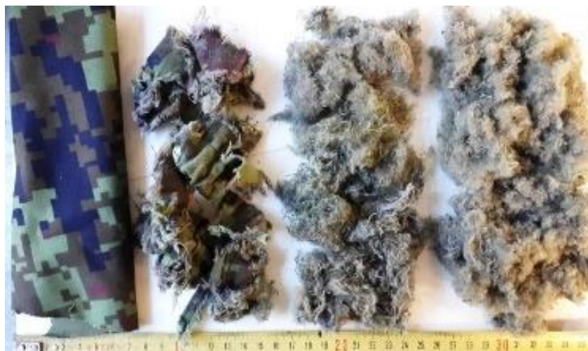
Joonis 4.4. Materjal nr 3 purustatud tulemused erinevatel peenestuselementide pöörlemiskiirustel
