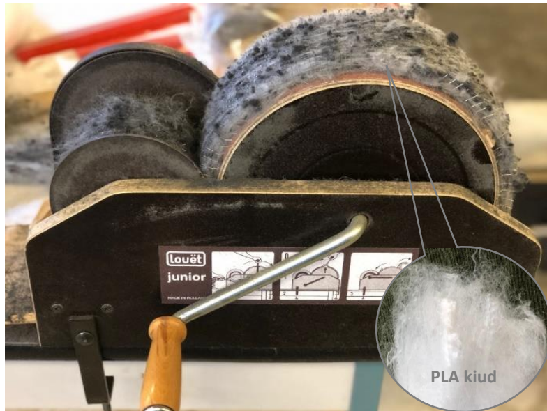
Joonis 4.8. Materjali nr 4 ja PLA segu kraasimine trummelkraasiga
