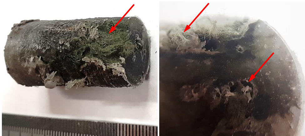
Joonis 4.22. Esmase katsetuse tulemusena moodustunud defektid filamendis (segunemata kiud)
