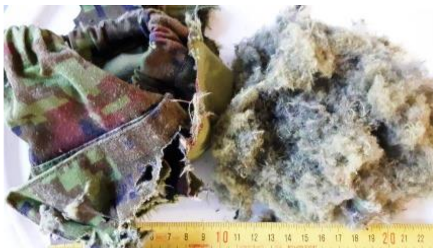
Joonis 4.2. Purustamiseks ettevalmistatud erineva paksuse ja furnituuriga tekstiilitükid materjalist nr 3 ja purustatud materjal.
