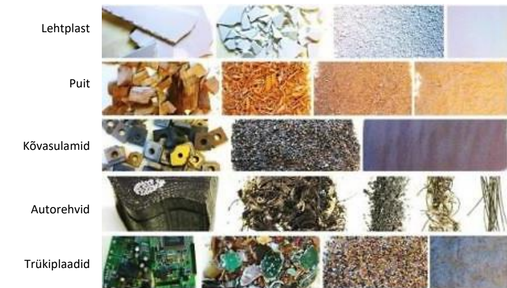
Joonis 2.4. Desintegraatorjahvatatud taaskasutatavate materjalide näidised (Goljandin, 2018)
