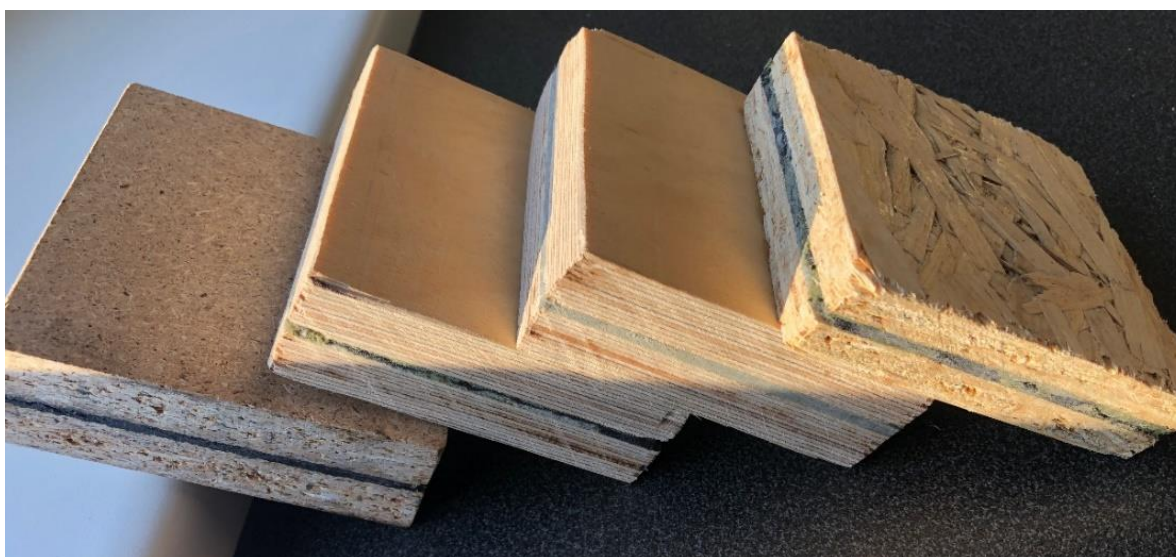
Joonis 4.14. Erineva kiulise koostisega tekstiiljätmetest valmistatud komposiitmaterjalide näidised
