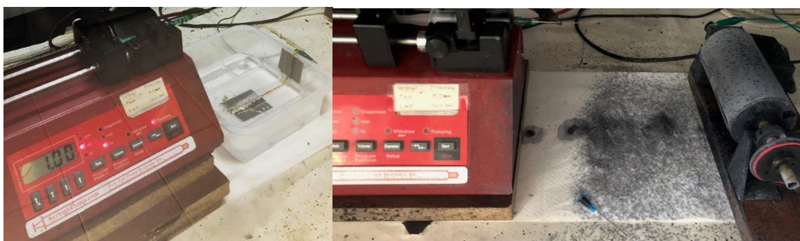
Joonis 4.19. Materjalidest nr 1 ja nr 4 valmistatud lahuse elektroketruise katsed
