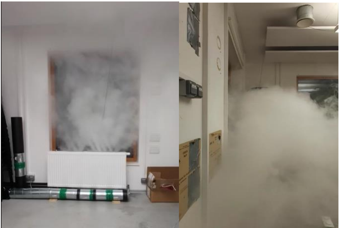
Pilt 13 - Radiaatorjahutuse suitsukatse. Vasakul kiire kiirus ja paremal aeglane kiirus (autori pildid)
