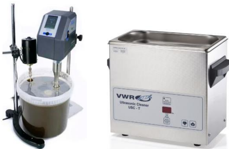
Joonis 9. Ultrahelilainete tekitamise võimalused laboriskaalas. 35,36
