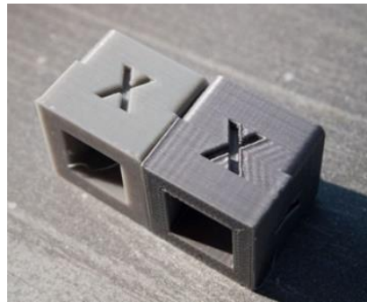
Sele 1.4 Parempoolsel objektil on näha väljapoole paisunud kihid [5]
