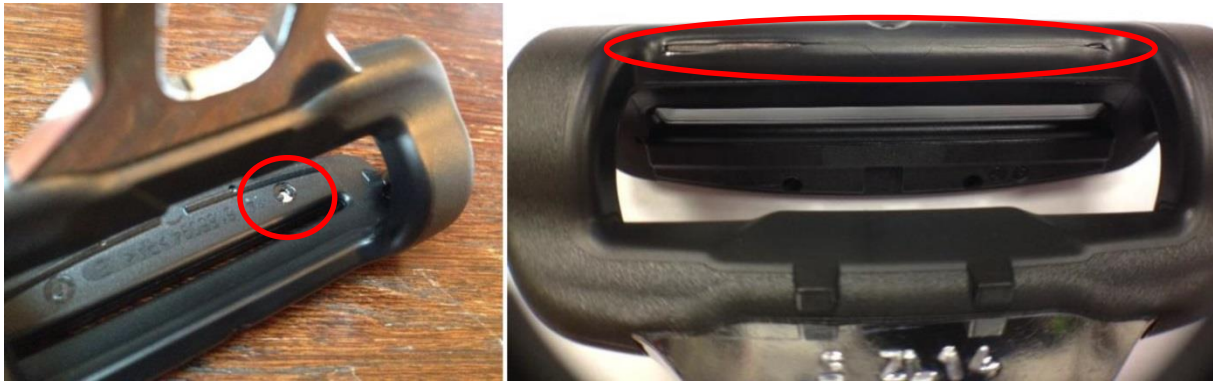
Sele 1.4 Kontuurihälbest põhjustatud mitte täielik vormi täisvoolamine
