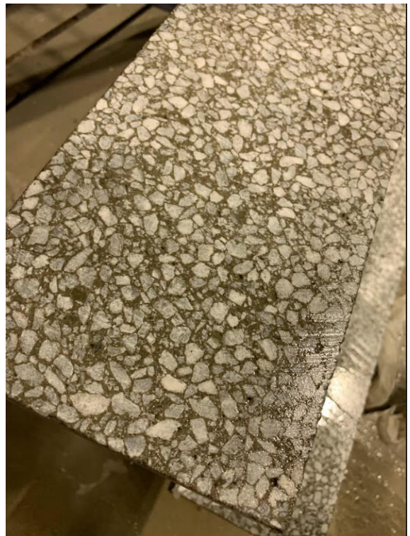
Pilt 13. Terratso detail pärast abrasiivlihvimist
