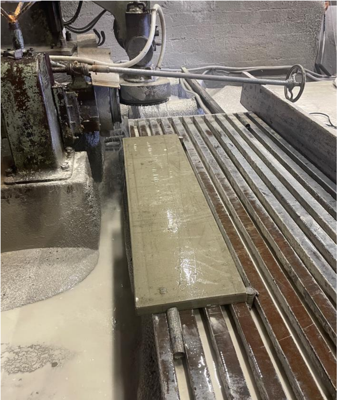
Pilt 19. Abrasiivlihvimise katse alustamine
