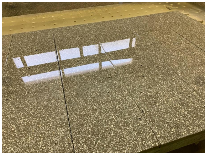
Pilt 16. Poleeritud terratso detailid
