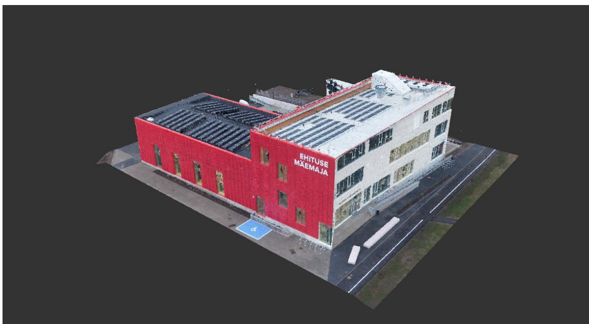
Joonis 5. Droonfotogramm-meetrilisel meetodil loodud Ehituse Mäemaja tihe punktipilv programmis Autodesk ReCap.
