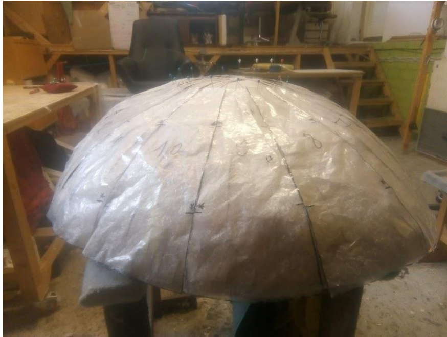
L2. Joonis 1. Fotel on kuvatud Maffam Freeform kiigu põhja mulaaž, mida kasutas autor lõigete valmistamiseks, et valmistada kiigu iste. Autori foto
