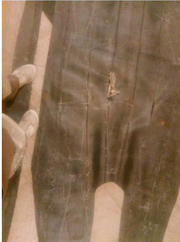
L2. Joonis 3. Foto süsta põhjamaterjalile kantud istme detailid ja projektis kasutatud materjali kuluvusaste. Autori foto
