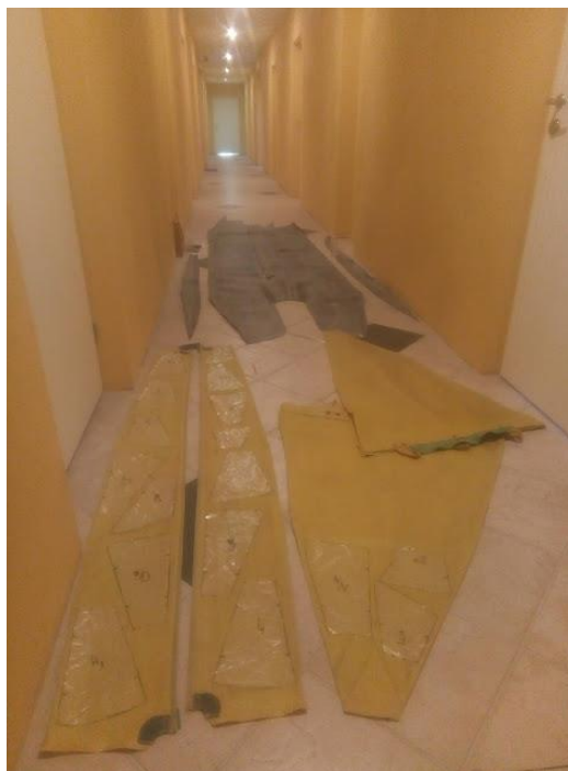
L2. Joonis 2. Fotel on kuvatud lahti võetud tekstiilsüsta katte materjalid. Fotel on näha mulaažilt võetud lõigete paigutamise poolik protsess. Autori foto
