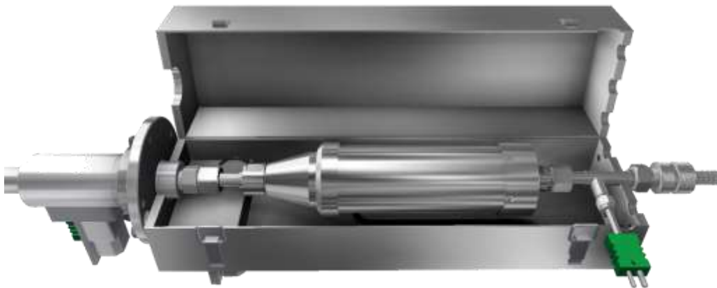
Sele 4.2. Impactor Johnas kuumutatavas korpuses [41]
