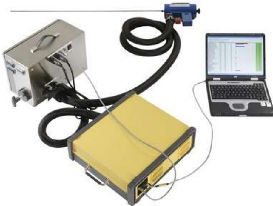
Sele 3.7. Portatiivne gaasianalüsaator DX4000 ja proovi võtmise seade [14]
