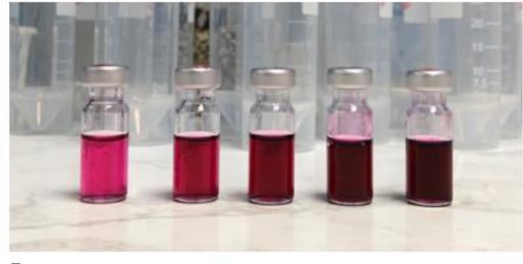
Joonis 6. Ligniini lahused proovist: A - kuusk; B - mänd; C - kask; D – kallaspappel
