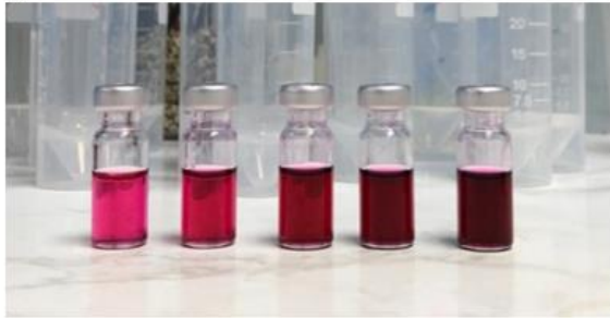
Joonis 6. Ligniini lahused proovist: A - kuusk; B - mänd; C - kask; D – kallaspappel
