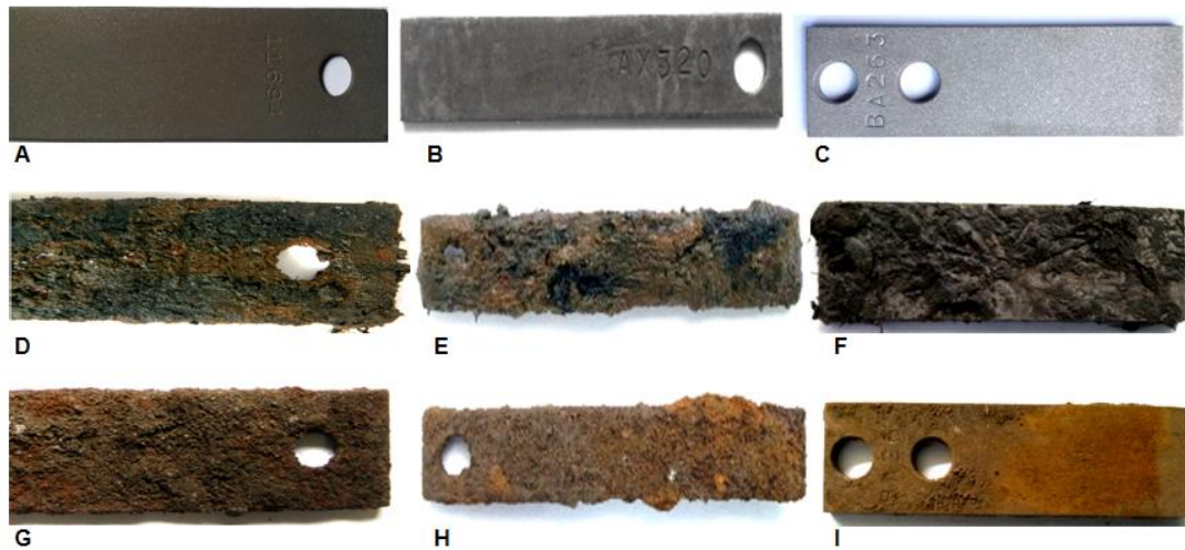
Joonis 4.6 Metallplaadid katse alguses ja lõpus [11]
