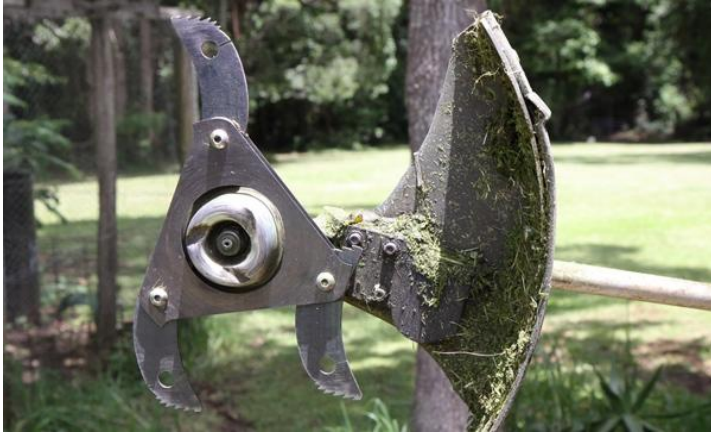
Sele 5-2 Tsentrifugaaljõul väljapöörduvate lõiketeradega lõikepea[7]
