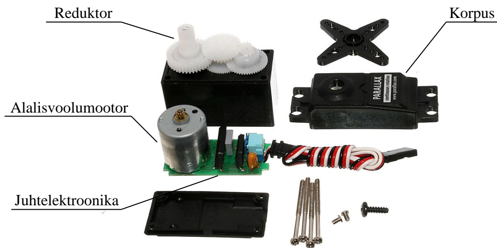
Joonis 7.6. Pidevpöörlemist võimaldav kiirusreguleerimisega servomootor lahtivõetult [14]
