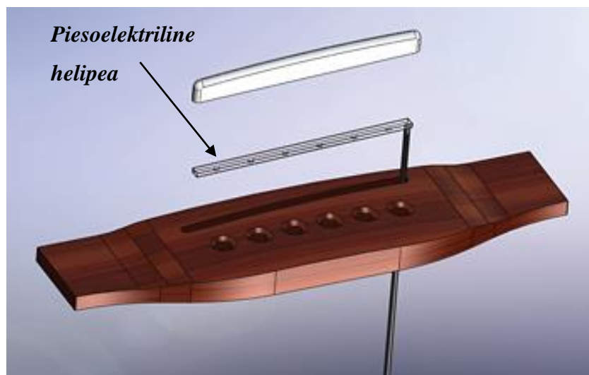
Joonis 3.2. Piesoelektriline helipea ehituse ülevaade [4]
