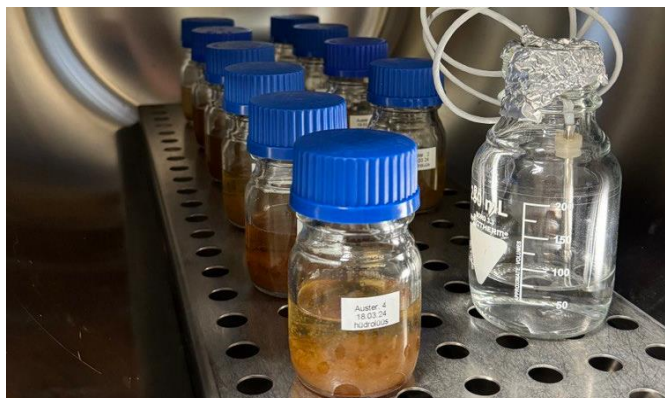
Joonis 11. Õlleraba, austerserviku ja shiitake proovide hüdrolüüs autoklaavis
