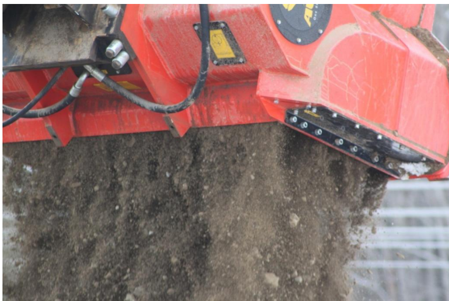
Joonis 1-18 Völlpurusti purustab algul suure tootlikkusega põlevkivi
