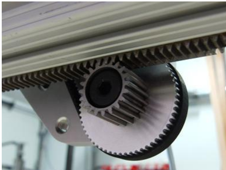
Sele 2.10. Hammaslati ja hammasratta ülekanne CNC masinas
