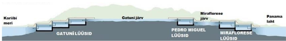
Joonis 3. Panama kanali lüüside asukohad
