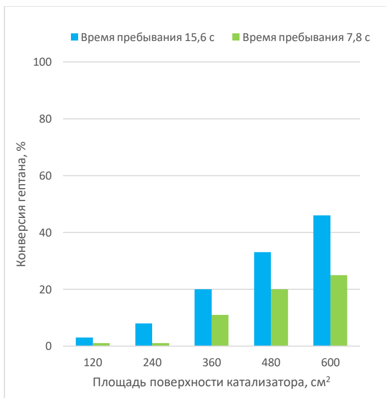
Рисунок 3.5. Влияние времени пребывания на процесс ФКО гептана (начальная концентрация 10 ppm, относительная влажность 6 %, источник излучения UV-A)
