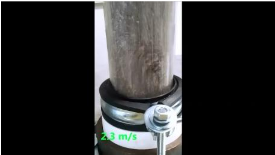
Sele 3.12. Kiht kiirusel 2,3 m/s. Toimub kihi täielik keemine
