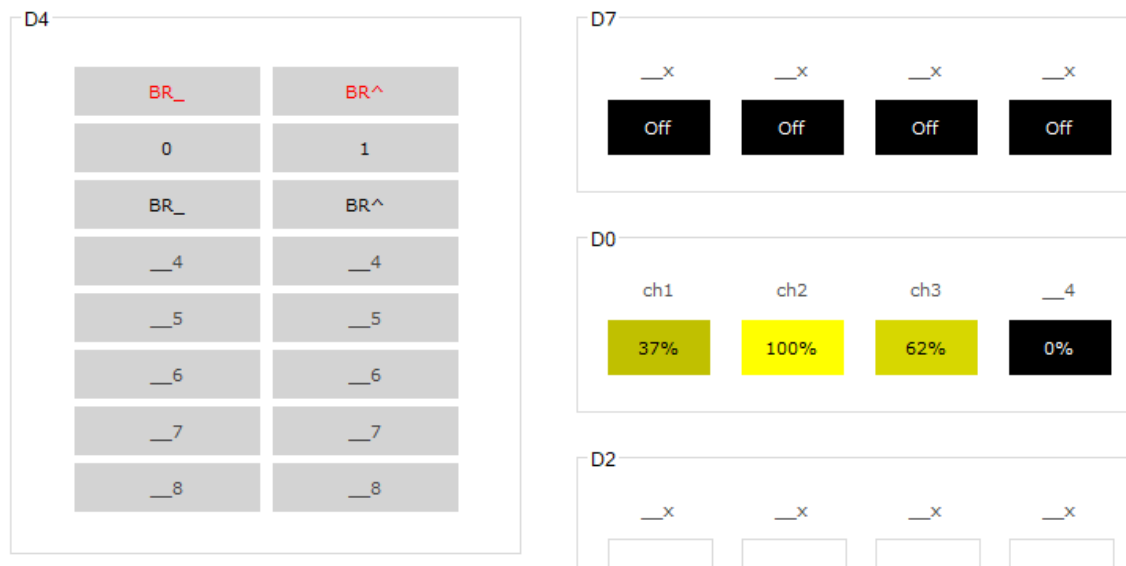
Joonis 5. KNX Virtual – lülitite ja lampide moodulite olek ETS 6 konfiguratsiooni alusel
