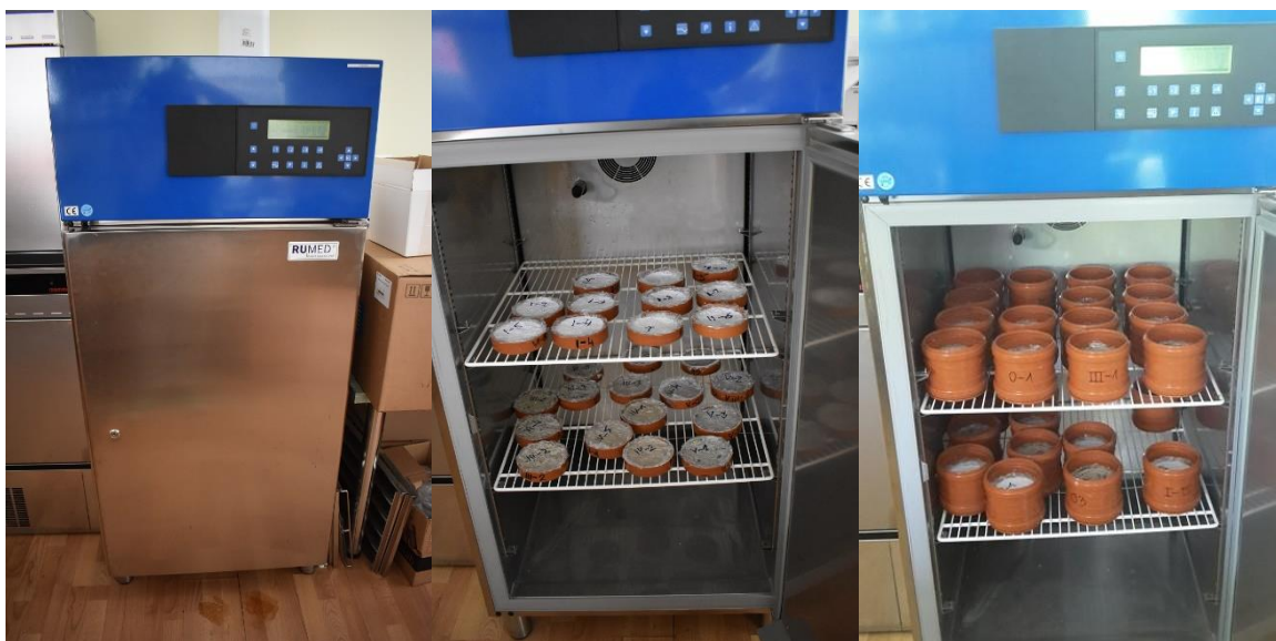
Joonis 3.7...3.9. Kliimakamber RUMED; sorptsiooni/niiskuspuhverduse katsekehad; veeauru läbilaskvuse katsekehad (erakogu)
