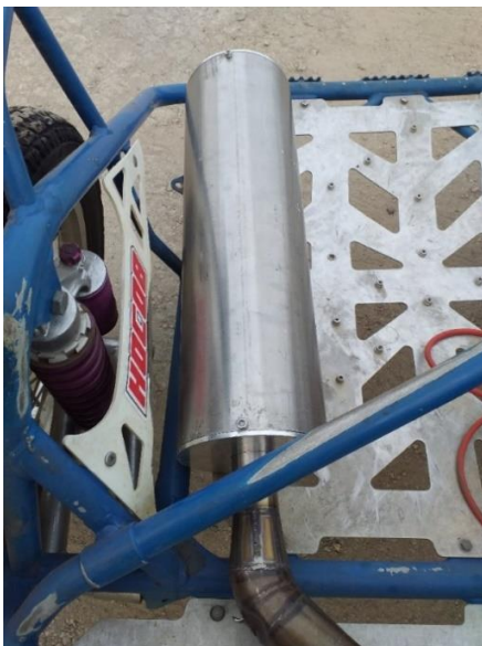
Joonis 3.11 Prototüüp 1 valmis summuti koos leegitoruga
