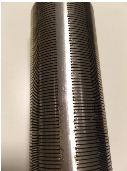
Joonis 3.15 Prototüüp 2 mikroperforeeritud valmis toru
