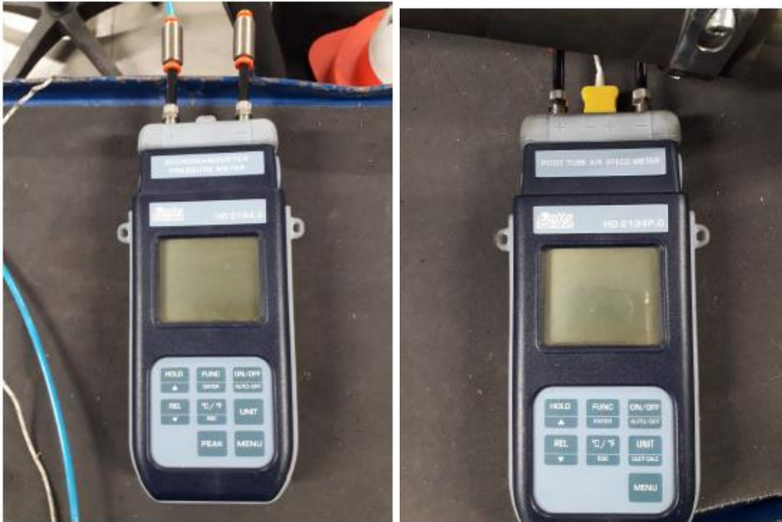
Joonis 2.13 Summuti vasturõhu mõõtmise mõõteseadmed
