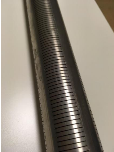
Joonis 3.10 Prototüüp 1 valmis mikroperforeeritud toru
