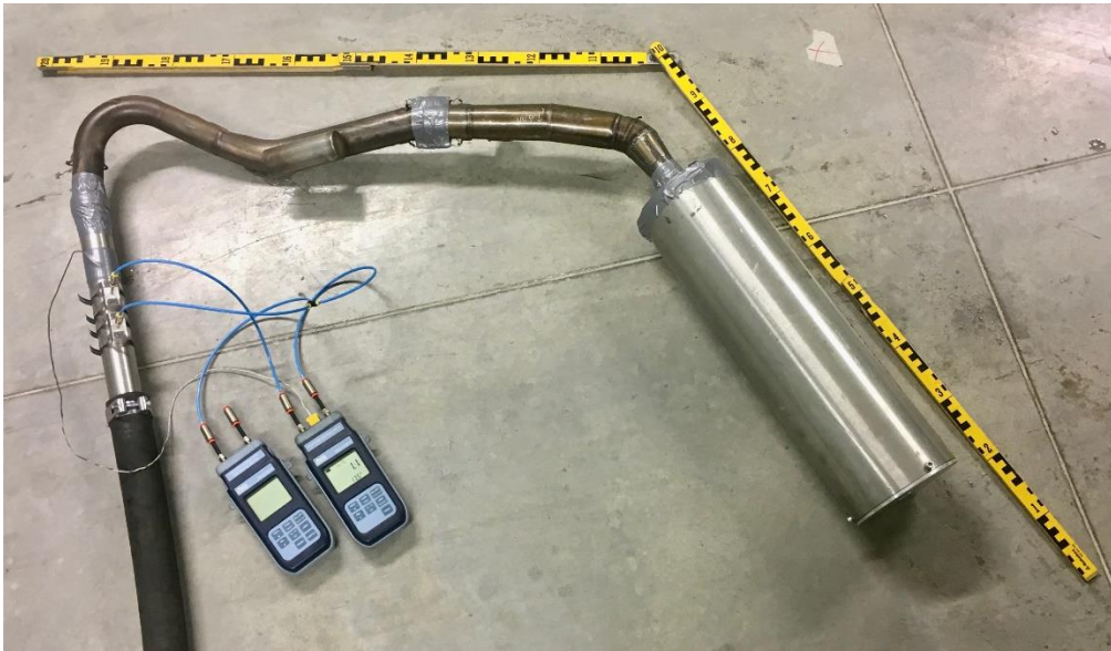
Joonis 3.19 Prototüüp 5 summuti vasturõhu mõõtmine
