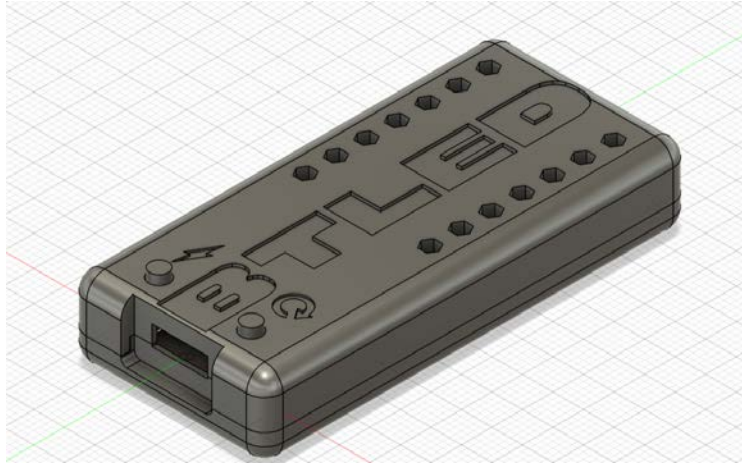
Joonis 4. Fusion360 modelleerimistarkvaras loodud arendusplaadi korpus vol. 2.
