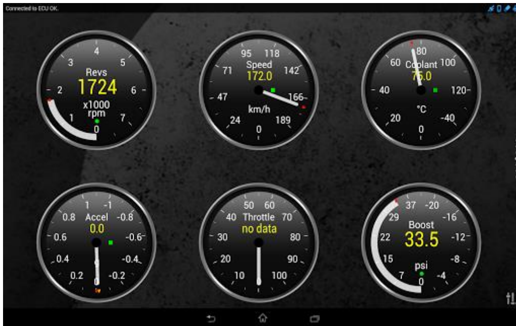
Joonis 9. Kuvatõmmis nutitefonis töötavast rakendusest Torque, pildil on näha reaajas sõiduki mootoripöördeid, sõiduki kiirust, jahutusvedeliku temperatuuri [34].
