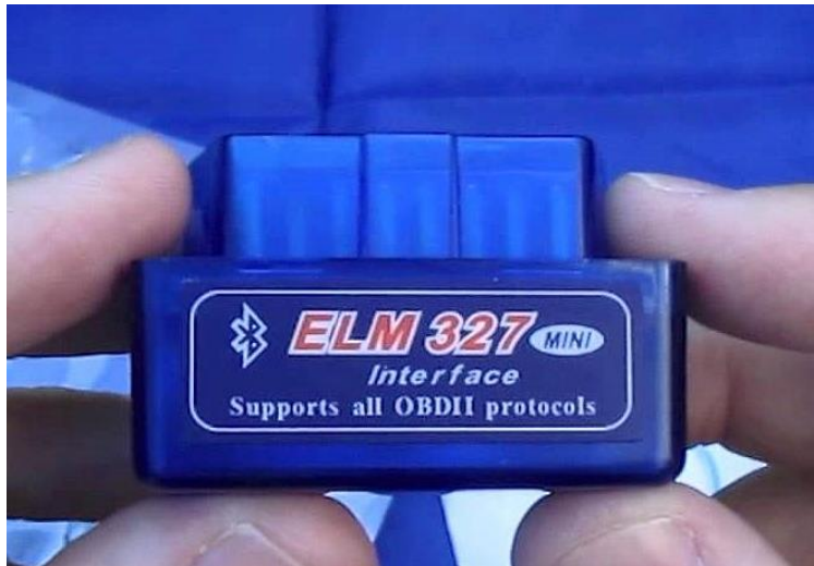
Joonis 11. ELM-327 adapter, sisestatakse sõiduki OBD pessa [37].
