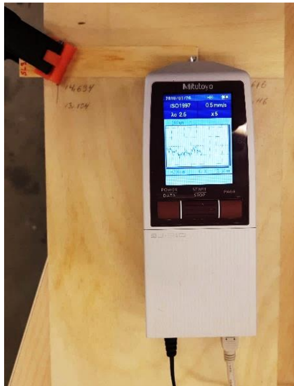
Joonis 2.3 Pinnakareduse mõõtmine
