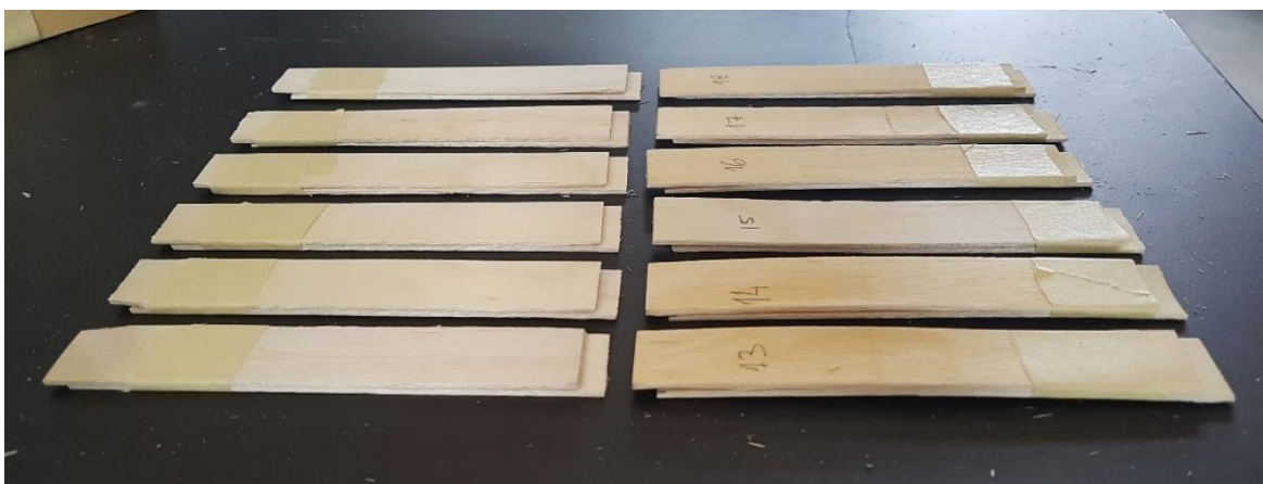
Joonis 2.5 Katsekehad koos abitükkidega
