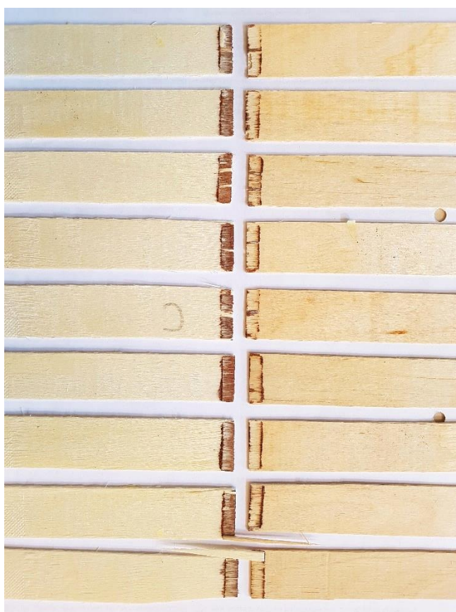
Joonis 3.6 Haava (vasakul) ja halli lepa (paremal) kombinatsiooni liimühenduse purunemise pinnad
